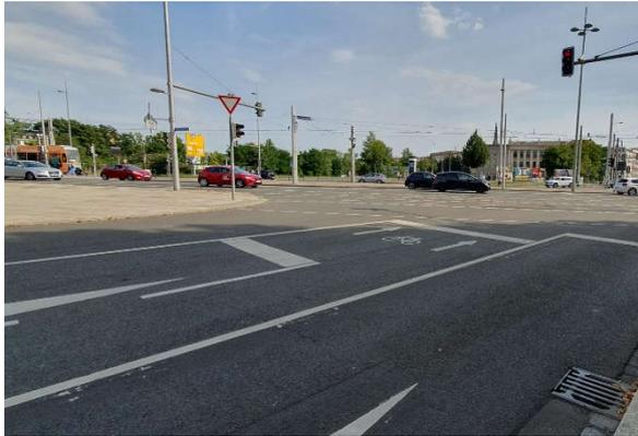
Abbildung 46: Aufgeweiteter Radaufstellstreifen (Leipzig)
