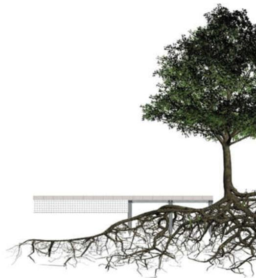
Die Wurzelbrücken bestehen aus Gittermodulen aus Stahl und sind hochbelastbar. Die Gittermodule werden auf Schraubfundamenten befestigt. Vor dem Einbau wird der Wurzelraum sondiert, anschließend werden die Fundamente schonend zwischen den Wurzeln eingeschraubt. Somit wird der Wurzelbereich geschützt und Beton in sensiblen Wurzelbereichen vermieden. Gegenüber Wurzelbrücken aus Stahlbeton sind Wurzelbrücken aus Metall flexibler in der Gestaltung. <sup>46</sup>
