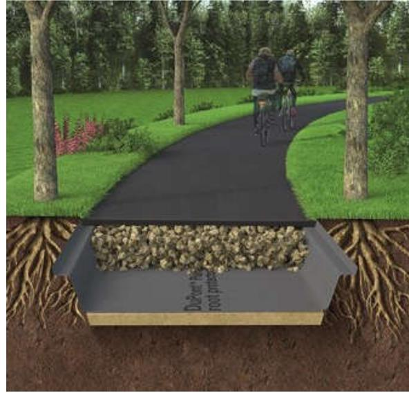
Abbildung 18: Linearer Wurzelschutz (Trog)
