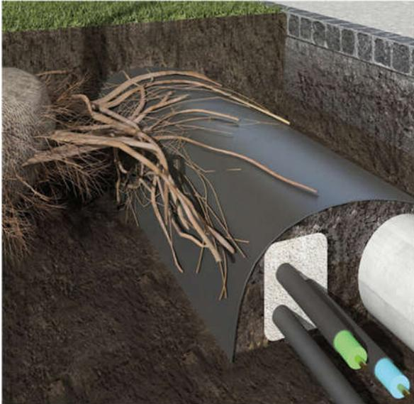
Abbildung 17: Linearer Wurzelschutz
