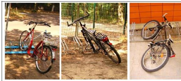
Abb. 50: Schrägstand an Vorderradhaltern
